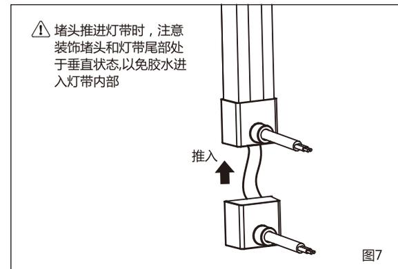
(8)、将灯带的尾部四周涂上填充胶，再将堵头推入灯带的尾部，如图8所示；
