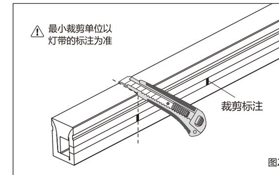
(3)、将灯带的一端铜箔(灯带背面胶体切开)露出，如图3所示；
