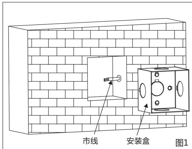
2.将安装盒平行埋入墙壁内,凹凸于平面不妥,将市线与产品接出的输入线接好,如图2所示；
